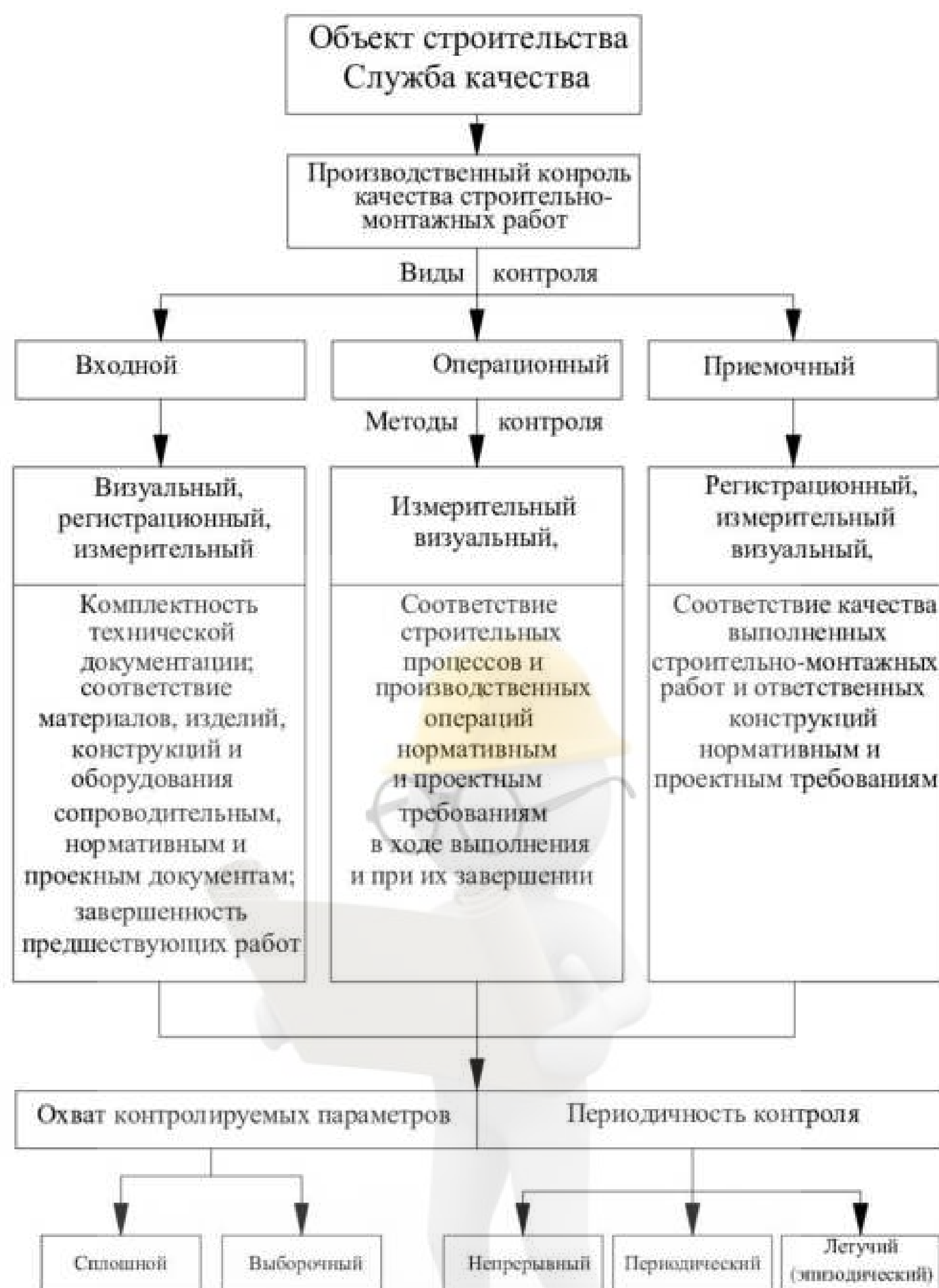
Рис. 22 - Схема производственного контроля качества строительно-монтажных работ
