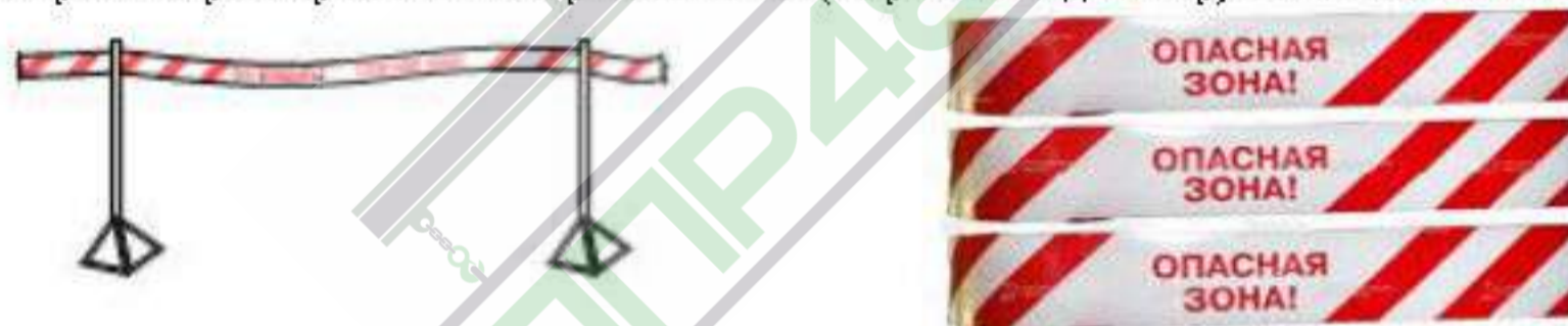
Рисунок 5 - Расположение полос сигнального и контрастного цветов на сигнальной ленте
